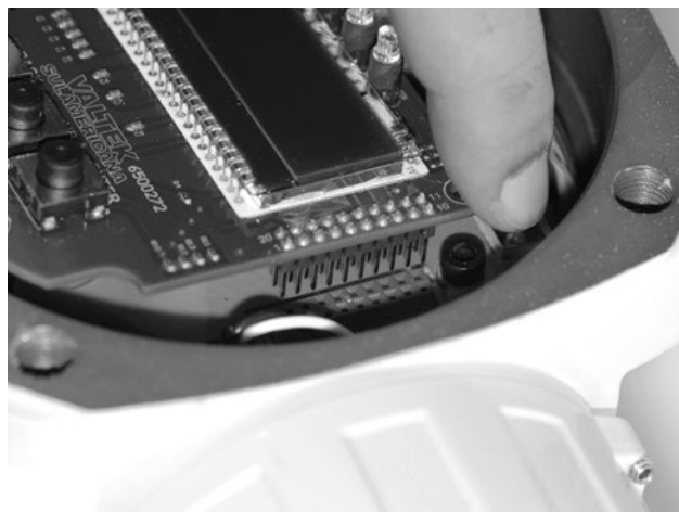
Figura 28 – Remoção da placa da interface com o usuário
