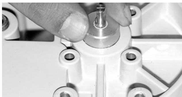
Figura 30 – Remoção do conjunto do potenciômetro
