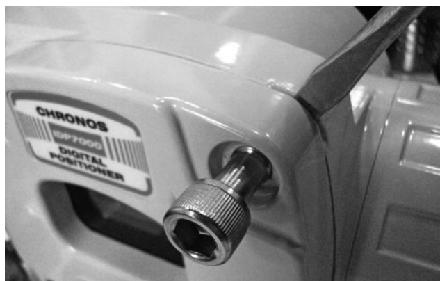
Figura 26 – Alavancagem da tampa frontal
